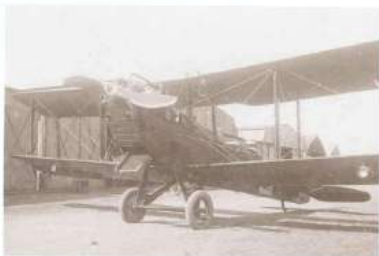
El Napier DH-9-60 estaba provisto de faros de iluminación nocturna.
