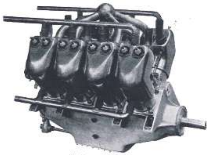
Motor E.N.V. que sustituyó al motor Levavasseur. Más potente, tenía 40 CV de potencia máxima.
