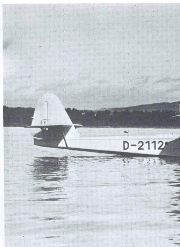
Dornier Wal 31 (motores BMW VI) en versión de pasajeros (puesto de pilotos retrasado). Los Wal 31 fueron los primeros Wal fabricados en Alemania, incorporando muchas modificaciones respecto de los anteriormente hechos en Italia, Holanda y España.
