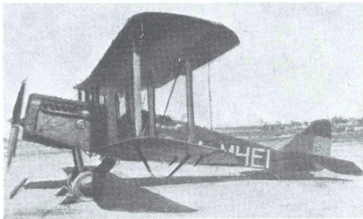
De Havilland DH-4 , con motor Rolls Royce de 300 CV.
