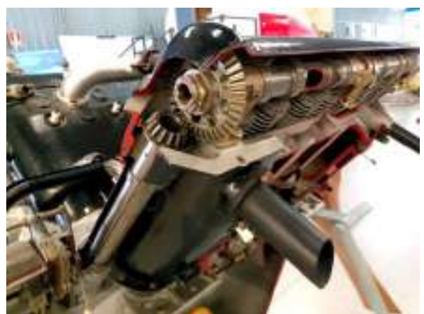
Figura 1: En esta imagen se ve el árbol de levas y los engranajes cónicos de conexión con el árbol de transmisión desde el cigüeñal.
