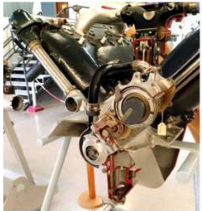
Figura 3: en esta imagen pueden verse las bombas de agua y aceite, así como una magneto instalada y la conexión para la otra magneto. Desde la bomba de agua parte el tubo (negro) de entrada de agua de refrigeración a ambos bloques.
