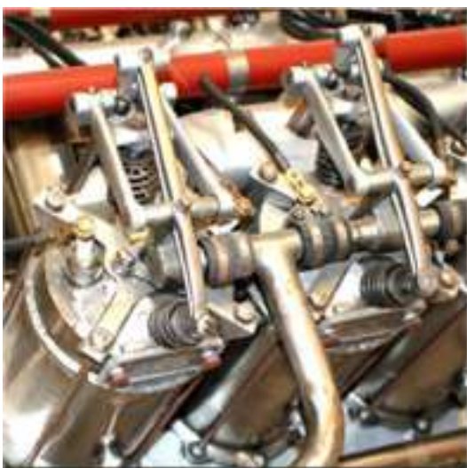
Figura 2: Detalle de las sujeciones superiores de los cilindros y el juego de balancines y válvulas.
