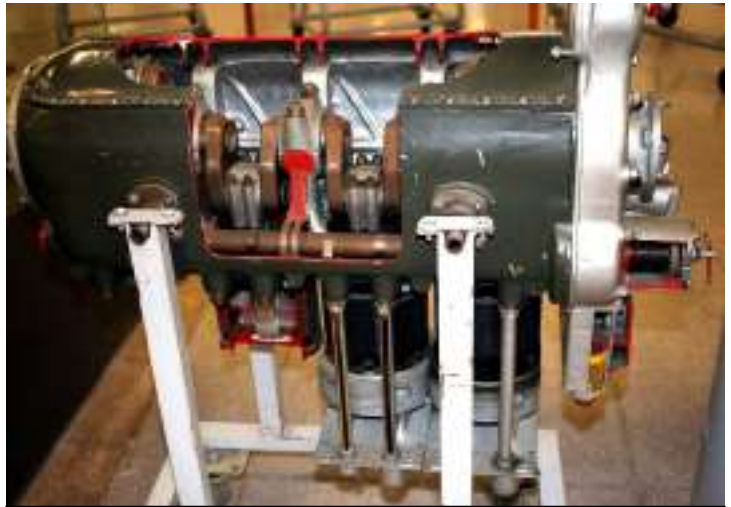
Figura 1: motor en exposición recortado mostrando articulaciones de cigüeñal y bielas.
