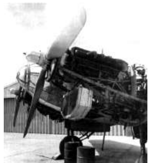
Figura 5: Motor Merlin 500-29 instalado en un avión CASA 2111.
