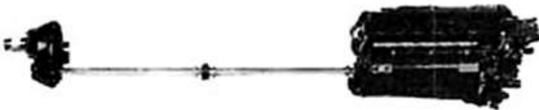
Figura 5: Vista lateral del modelo E V-1710 que muestra los dos ejes de extensión de 4 pies de largo y 2,5 pulgadas de diámetro que terminan en la caja de engranajes reductores de la hélice. La flexión y desalineación del fuselaje se controlan mediante acoplamientos flexibles estriados internamente.
