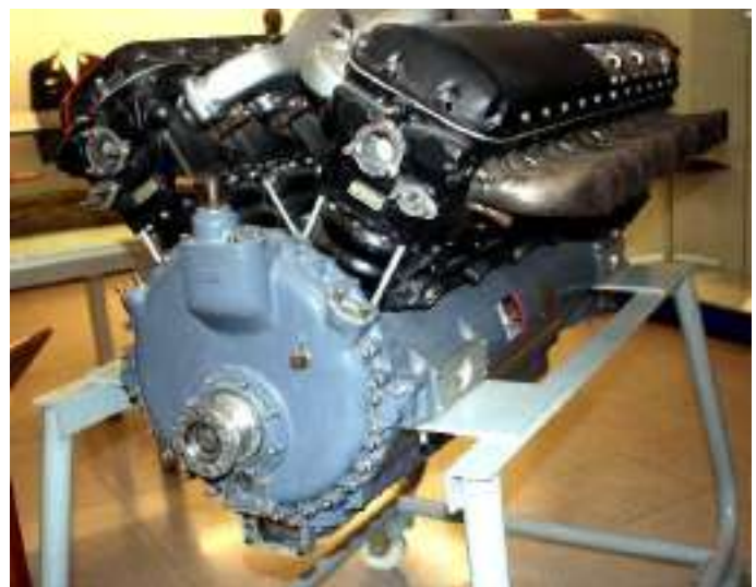
Figura 1: esta imagen muestra la brida delantera, extensión del cigüeñal, a la que va atornillado el eje de extensión para la hélice.
