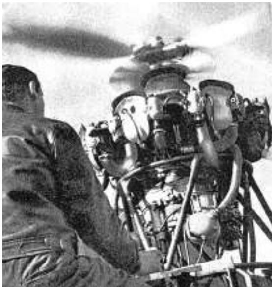
Alción en instalación vertical para helicópteros.
