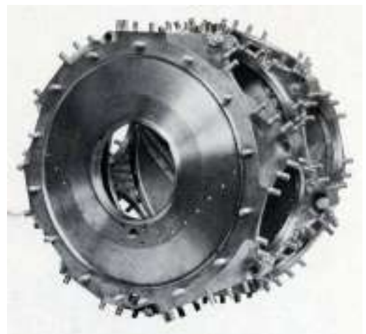
Cárter principal compuesto por cuatro carcasas unidas mediante remaches.
