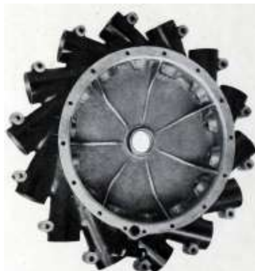
Cárter del difusor mostrando las salidas tangenciales para cada cilindro.
