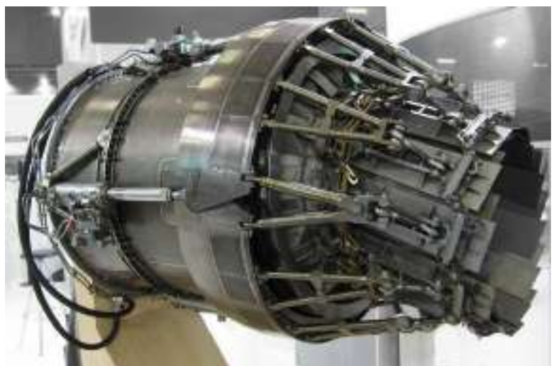
Figura 1: TVC (tobera de control vectorial de empuje)
