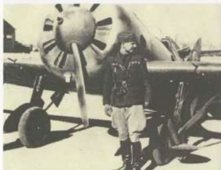
En este "Supermosca", de los contruidos en La Rabasa y capturado en la zona de Balaguer, se puede apreciar de forma difusa la tobera en forma de "T" en la parte inferior del escudo frontal, característico de todos los tipos 10 con motor M-25 V.
