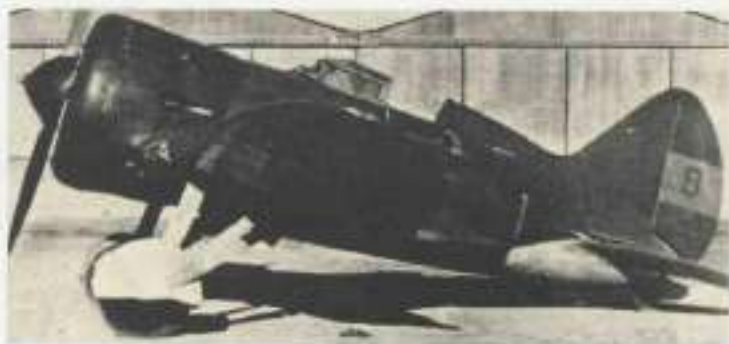
Conocida pero muy descriptiva fotografía de la apariencia de los primeros "Moscas" republicanos, del famoso 9 negro, primer I-16 capturado intacto por los nacionales. Puede observarse el capó pintado de negro, las ametralladoras ya desmontadas de los alos y el buje de la hélice, cónico y nudo.
