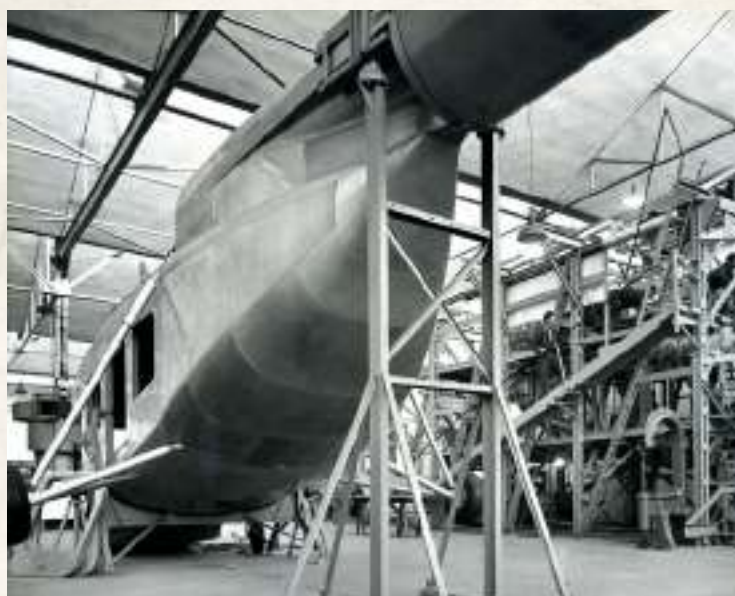
Los dos prototipos AC-21 en la factoría de Getafe de CASA en fecha desconocida, con seguridad posterior a la suspensión de su producción. El XZ.5-2 a la derecha, en el útil de montaje del fuselaje
