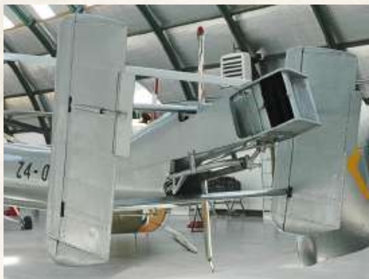
Las dos derivas y la tobera bifurcada del AC-14 del Museo de Cuatro Vientos son totalmente distintas, tanto de las empleadas en los prototipos como de las montadas en el AC-13
