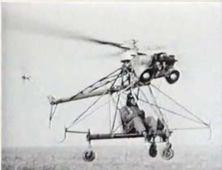
El C-100 pilotado por Gérard Henry. Nótese la ubicación de los dos ventiladores para refrigeración del motor
