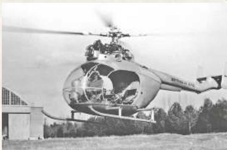
El segundo prototipo AC-14. Destaca, además del mayor tamaño comparando con el AC-13, la configuración de las dos derivas y la tobera bifurcada, muy diferentes también
