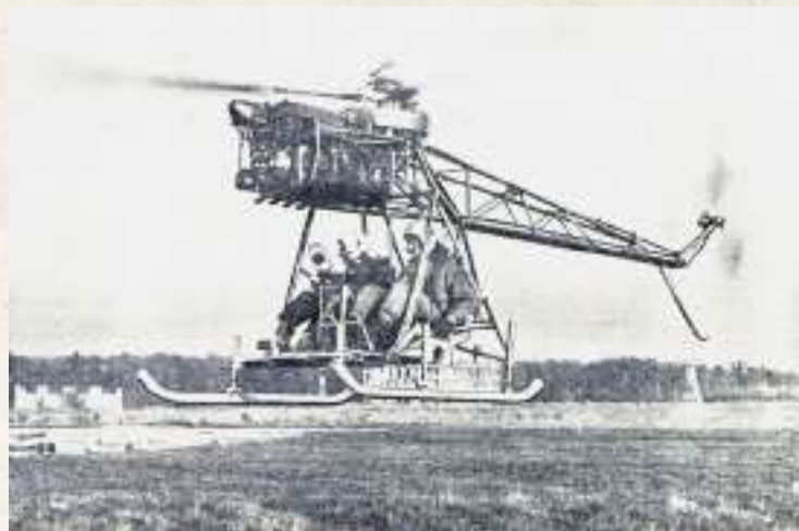
El MC-101 probablemente durante su primer vuelo del 11 de noviembre de 1952, sin parabrisas ni carenado del motor ni ventiladores
