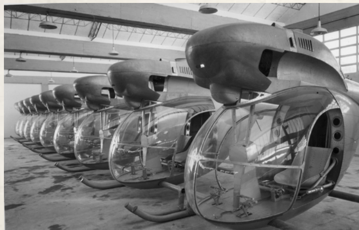
Estructuras de la preserie AC-12 en las instalaciones de AISA
