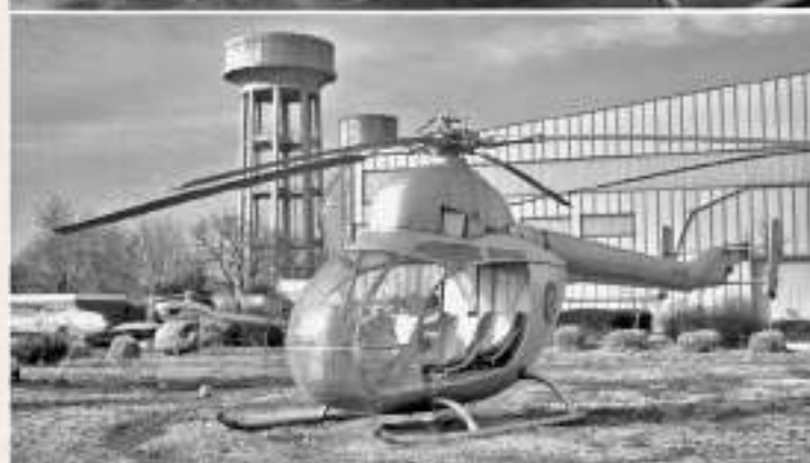
Arriba, grupo de estructuras de la preserie AC-14. Abajo, fotografía retrospectiva del AC-14 del Museo de Cuatro Vientos. Se observa la presencia en él de dos ventanas a cada lado por encima de los accesos a la cabina, que no aparecen en las ocho estructuras
