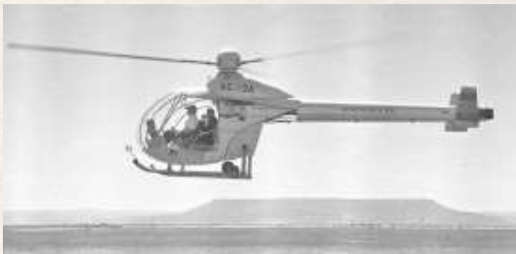
El AC-13 sobrevolando terrenos del INTA a escasa altura; el piloto es el capitán Rochon. Se puede observar en el extremo anterior del patín izquierdo una pequeña pértiga para toma de datos de vuelo
