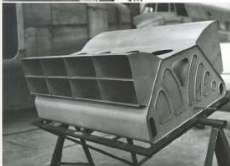
Dos detalles de la tobera bifurcada montada en el XZ.5-1
