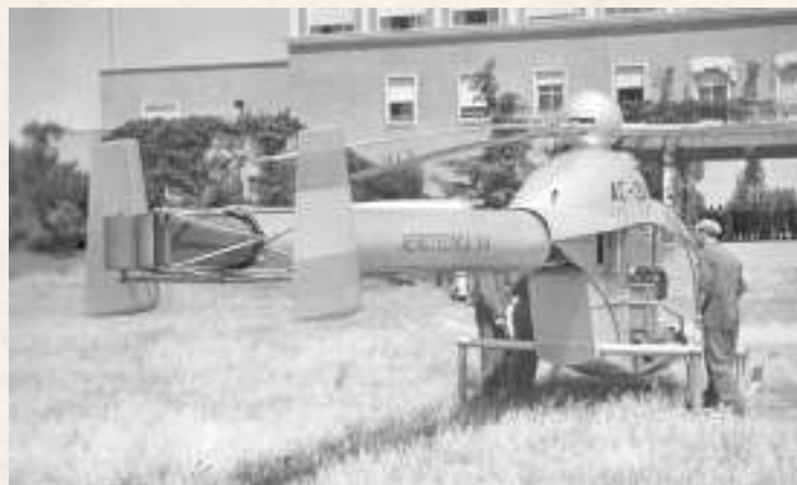
El AC-13 delante del edificio de la jefatura del INTA durante la demostración del 13 de junio de 1955. Nótese el diseño de su tobera bifurcada y las dos derivas
