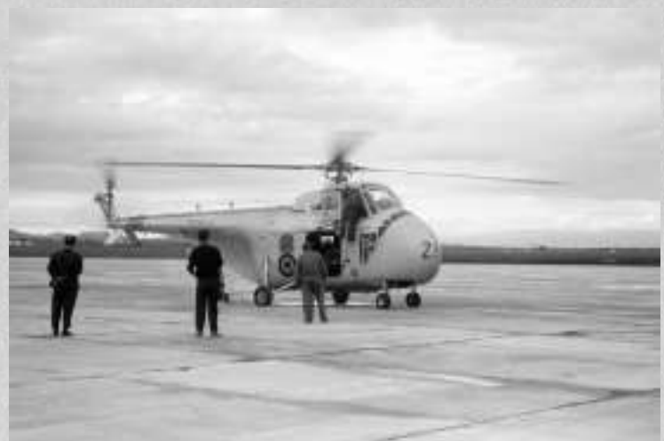
Otra vista del Z.1-4 en Manises, antes de la sustitución del boom rectilíneo. Fuente: AHEA 161(21) DIG
