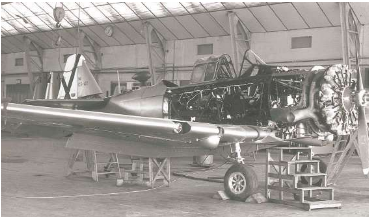
En este estado se hallaba el C.6-41 el 24 de septiembre de 1976, cuando le fotografiamos en la cadena de IRAN de AISA. Una vez terminada la revisión y probado el vuelo, se incorporaría a la 601 Escuadrilla el 17 de enero de 1977. (J.L. González Serrano).
