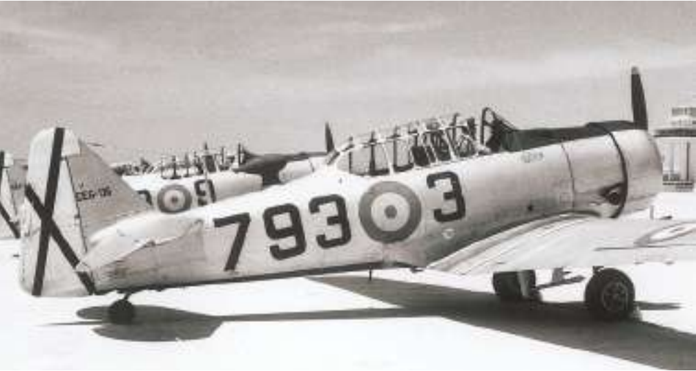
Uno de los CE.6 que tuvo destinados el 793 Escuadrón de la AGA fue el 136. Los CE.6 sólo llevaban un lanzacohetes doble Pilatus en cada semiala, aparte de las ametralladoras. Hasta el 20 de mayo de 1968, cuando el CE.6-136 resultó destruido en accidente en Pinto (Madrid), segundo la vida del teniente Julio Centelles Mojica, había efectuado 4.378 horas y 30 minutos de vuelo. (Juan Arráez Cerdá, archivo del autor).
