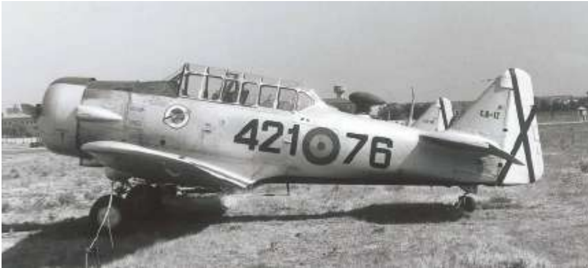
El C.6-12 fue uno de los últimos Texan del 421 Escuadrón. Obsérvese la posición de la antena de radio con respecto a la del gonio; en los T-6G, aquella estaba situada justo delante de ésta. Además, las cúpulas de los T-6D tenían siete montantes, mientras que las de los T-6G tenían cuatro. (J.L. González Serrano).
