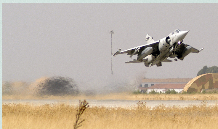
Despegue con dos tanques de combustible externos y la barquilla Barax de un F1M. Fuente: Ejército del Aire y del Espacio
