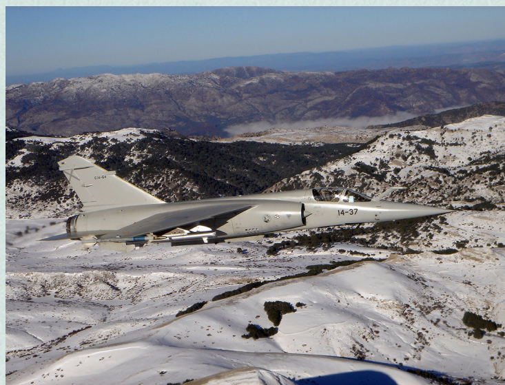
Mirage F-1M. Obsérvese la sonda de repostaje en vuelo, la barquilla Barax en el pilón interior y el AIM-9J en el pilón exterior. Fuente: Ejército del Aire y del Espacio
