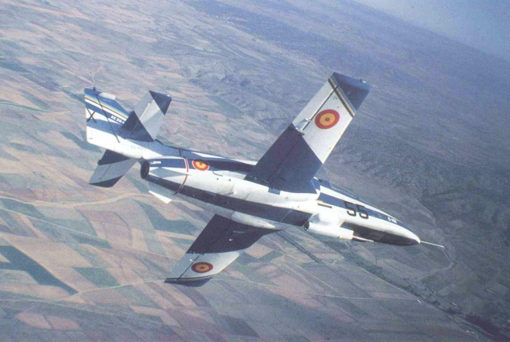
Avión C-101 en el que se aprecian las aletas ventrales.
