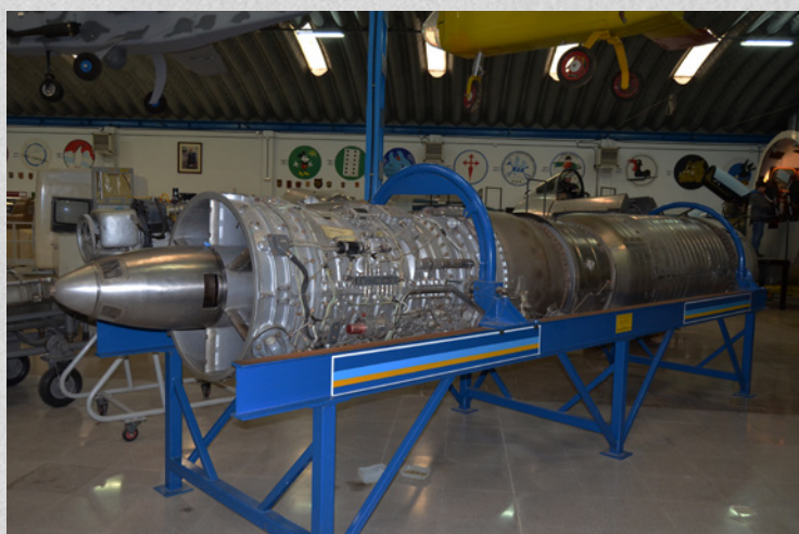
Turboreactor SNECMA Atar 9C del Museo de Aeronáutica y Astronáutica, en donde se ve el alojamiento de la APU (auxiliary power unit, la unidad o «motor de arranque» del reactor) en el interior del cono en primer plano (difusor de admisión).
