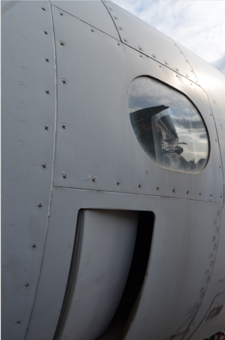
Una de las dos compuertas de admisión auxiliar de aire al despegue y el faro policía encima de esta. (Autor).
