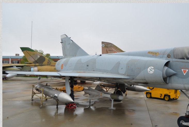
Admisión cónica retráctil del Mirage IIIEE (los souris ). Se puede ver un Matra en la panza del avión (Autor).
