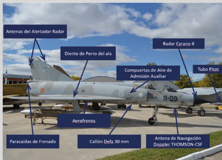
Elementos básicos del Mirage IIIEE señalados en la imagen (Autor).
