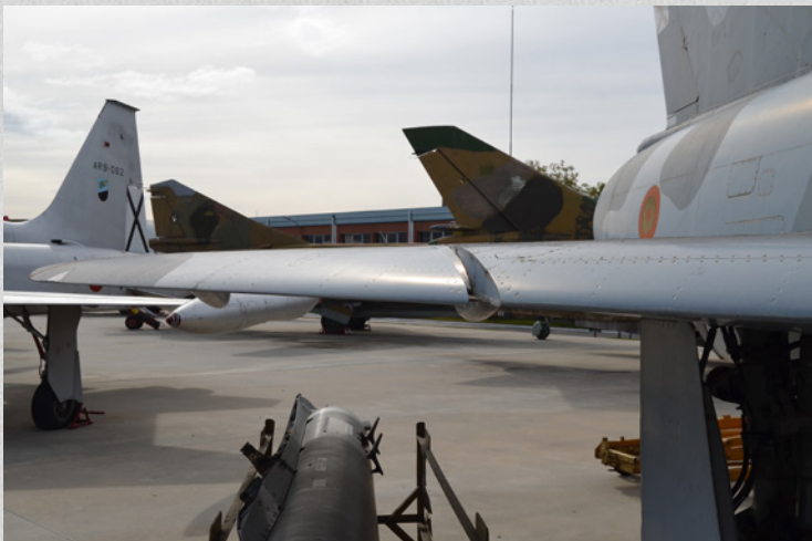
Diente de sierra del borde de ataque del Mirage IIIEE del Museo de Aeronáutica y Astronáutica (Autor).
